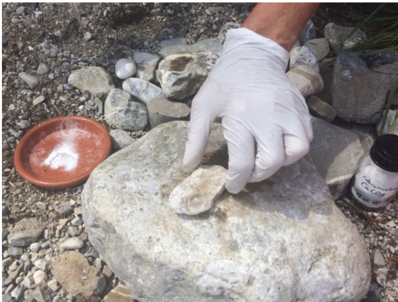
Schäumender Kalkstein, links in der Schale Calciumcarbonat-Pulver zum Vergleich © Keil
